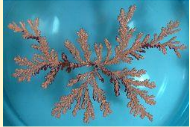
DLA klaster vzniklý elektrodepozicí sulfátu mědi
