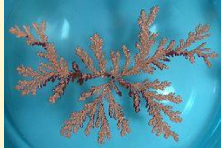
DLA klaster vzniklý elektrodepozicí sulfátu mědi
